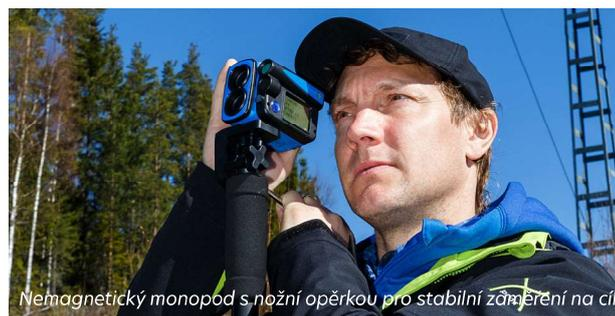
Nemagnetický monopod s nožní opěrkou pro stabilní zaměření na cíl
